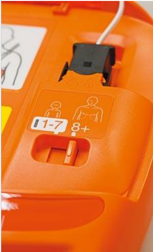
▲日本光電 AED 內部簡潔，只有一個電擊鈕，成人與小孩的電擊功率只用 1 個開關就可以切換。張鎧乙攝)
